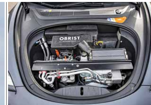
Kompakter „Zero Vibration“-Generator im Motorraum (oben). Laufruhe-Experiment: Der Motor dreht hoch, doch die hochkant oben auf dem Zylinderkopf stehenden Münzen beeinflusst das nicht – sie rollen weder davon noch kippen sie um
