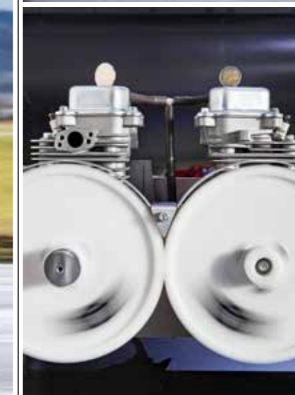
Kompakter „Zero Vibration“-Generator im Motorraum (oben). Laufruhe-Experiment: Der Motor dreht hoch, doch die hochkant oben auf dem Zylinderkopf stehenden Münzen beeinflusst das nicht – sie rollen weder davon noch kippen sie um
