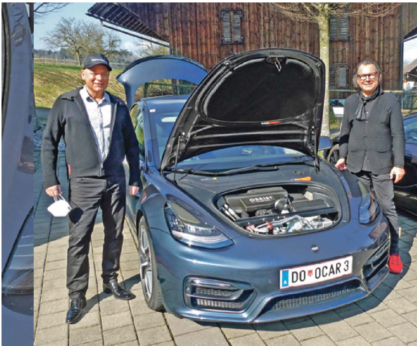
Frank Obrist 和 Frank Wolf 正在展示 Obrist Powertrain 开发的 HyperHybrid 动力系统，这辆改制后的特斯拉 Model 3 装载了一台紧凑发动机。相关数据直接显示在特斯拉中央显示屏上。
